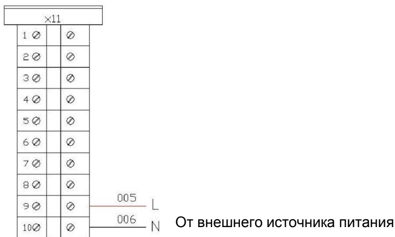
Рис. 7-3 Подключение источника питания цепей управления
