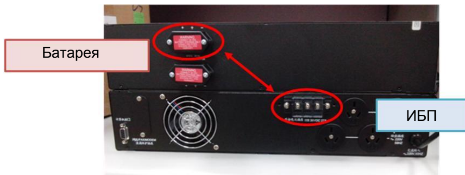
Рис. 10-4 Батарея и ИБП
