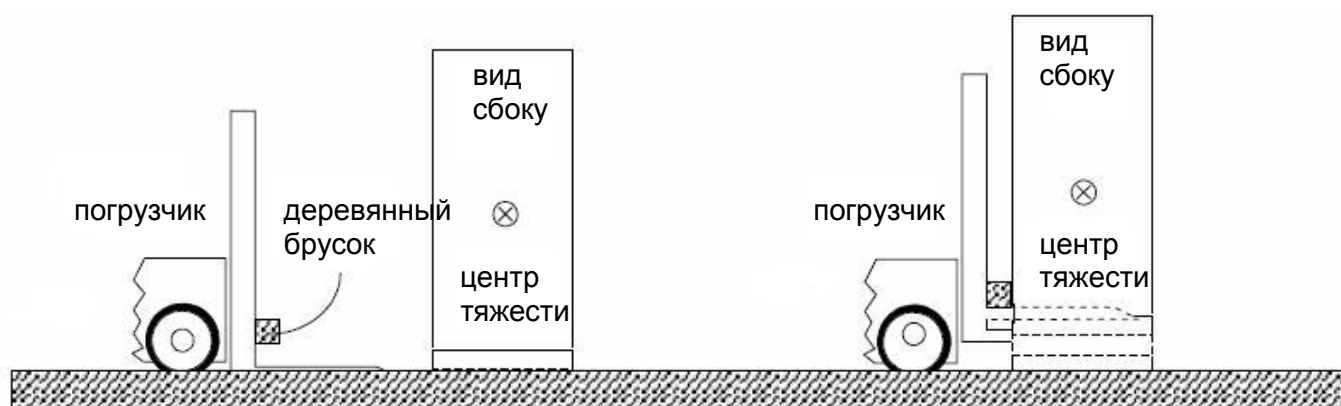
Рис. 6-10 Перемещение шкафа вилочным погрузчиком
